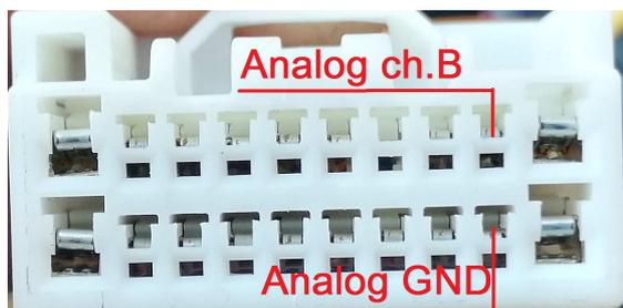
**Монтаж на модула MC7-RFx :** Конектор и свързване :
